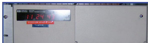
ภาพที่ ๕-๒ นาฬิกาปรมาณูซีเซียม ๑๓๓ ตราอักษร HEWLETT PACKARD
