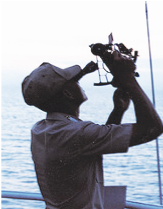
ภาพที่ ๓-๑ การวัดด้วยวงเวียนท้องฟ้าเพื่อหาดำบลที่เรือ
